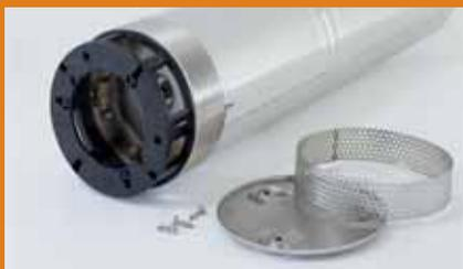
Насосы с решеткой на всасывании можно установить под любым углом, однако нужно следить, чтобы всасывающий патрубок всегда был ниже головной части насоса.
