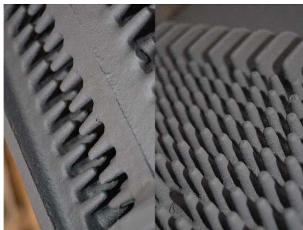
Рисунок 1. Внешний вид теплообменника.
