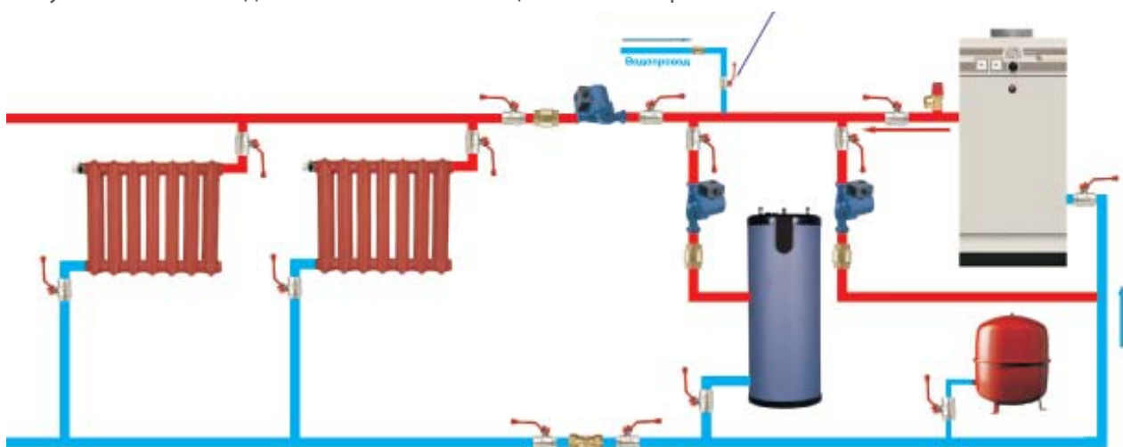
Рисунок 7. Схема подключения котла с принудительной циркуляцией теплоносителя.
