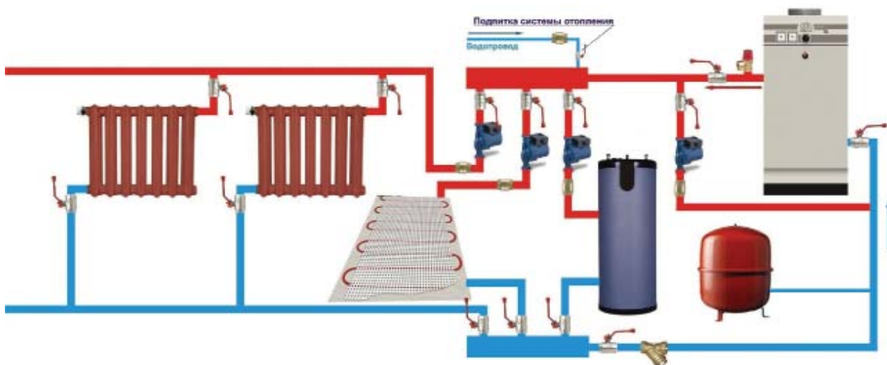
Рисунок 6. Схема подключения котла с общим коллектором.
